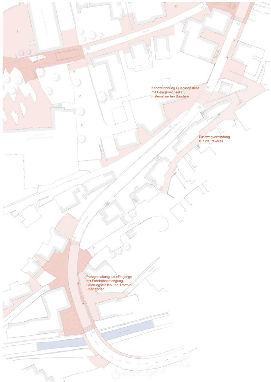
Abbildung 23: Gestaltungsansatz Via Lucmagn mit Platzgestaltung als «Eingang» und Aufwertung für den Fussverkehr (Wegführung Via Raveras und Querungsstelle Kantonsstrasse)
