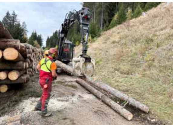
Sil descargo ei igl excavatur ni era tractor forestal in mied indispensabel
